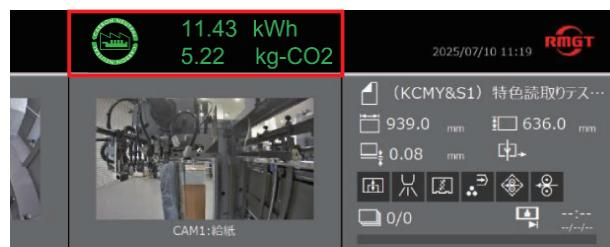
オペレーションスタンドの画面にリアルタイムで表示されている進行中のジョブの消費電力量とCO<sub>2</sub>排出量
